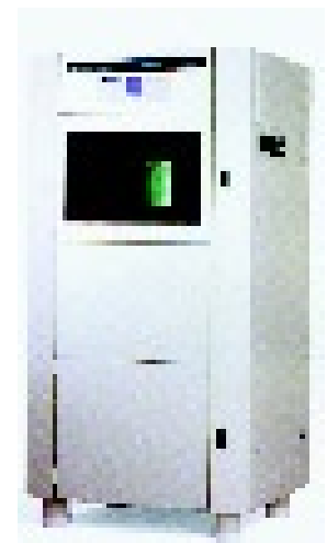
Lichtechtheitsprüfgerät Xenotest ALPHA HE: Mit diesem Gerät kann Lichtbeständigkeit normgerecht getestet werden.
