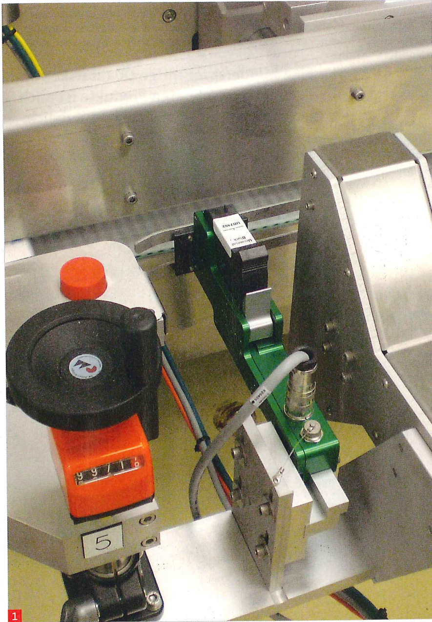
1. Druckkopf, seitlicher Druck auf eine Faltschachtel mit der Tinte Wolke Universal Black. (Foto: Wolke)
